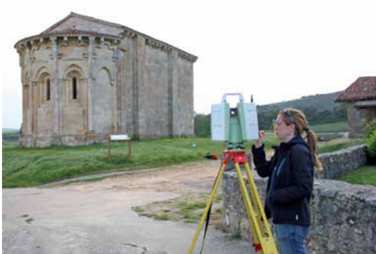
Laser eskaner baten bidez aztertu du eliza Amaia Mesanza topografoak. A. MESANZA
